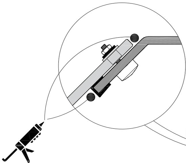
Место примыкания герметизировать нейтральным силиконовым герметиком
