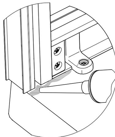
Крепление к стене в комплектации "без задних стенок"
