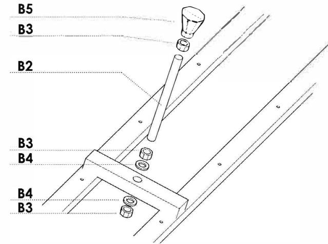
Стойка №1 устанавливается со стороны крепления экрана к каркасу
