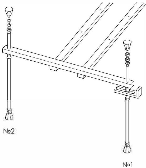
Зафиксируйте каркас на ванне с помощью саморезов (B9). При установке убедитесь, что расстояние между каркасом и корпусом ванны достаточно для установки слив-перелива (сифона).
